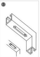
Закрепите монтажную пластину (для полой металлической двери)
