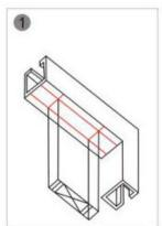
Расположите корпус замка так, чтобы он совпал с центром дверной коробки
