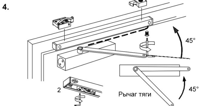
4. Установите тягу доводчика обязательно убедившись, что угол между ней и дверью - 45°. Затем переместите тягу в положение параллельно двери и закрепите винтом.
