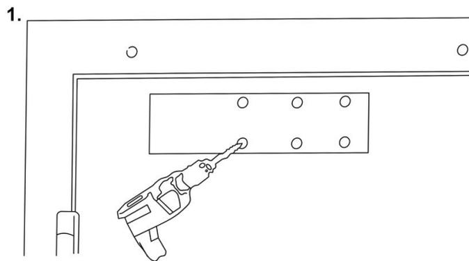
1. Просверлите отверстия в двери в соответствии со схемой разметки.
