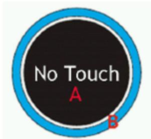
A – оптический датчик;
